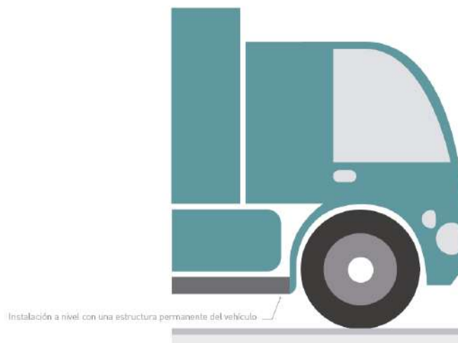
Figura 3. Forma del salvaguarda en la parte frontal
